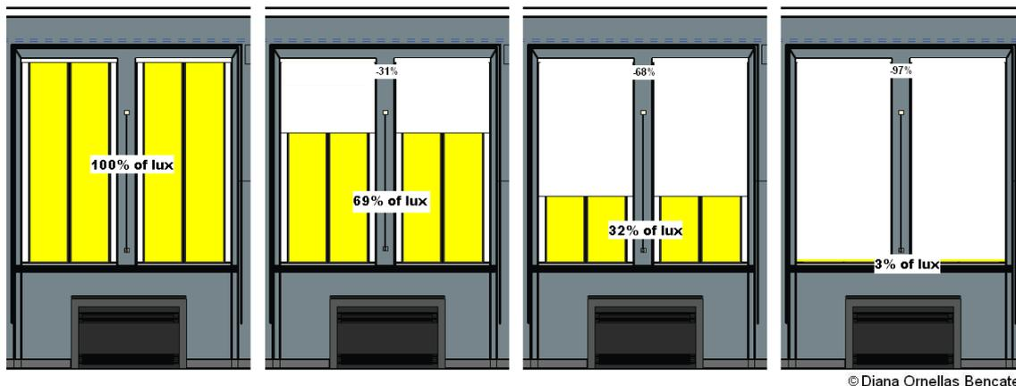
Figura 9 - Percentagem de iluminância verificada no interior da galeria com os blackouts a quatro alturas diferentes.
