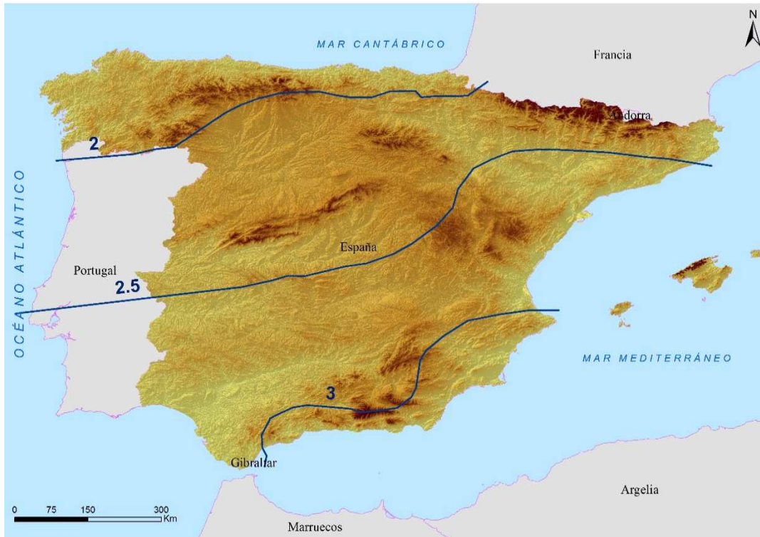
Fig. 4 Mapa del coeficiente corrector del umbral de escorrentía. La ubicación de la cuenca del río Eume señalada en rojo Fte: Modificado de J.R. Témez.
