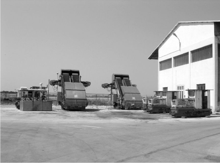
Fig. 2 Nastri trasportatori per ammassamento del sale.
