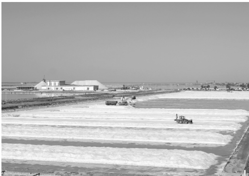
Fig. 5 Raccolta meccanica del sale detta "a travoni".
