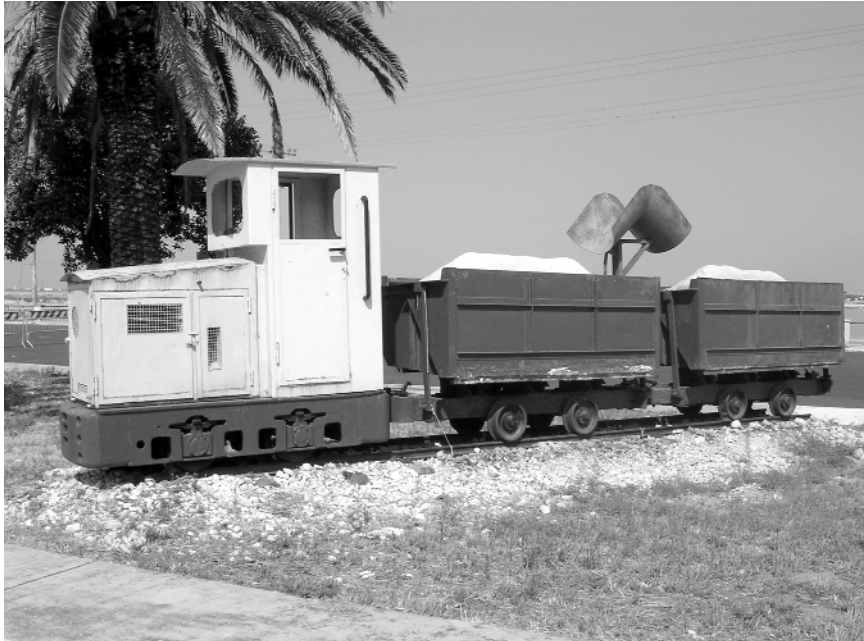
Fig. 1 Carrelli sbilicabili con motrice per raccolta sale (in uso anni '80-'90 del '900).
