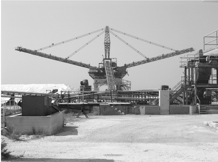
Fig. 4 Raccolta e ammassamento di sale con carro ponte.
