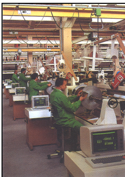
Figura 5.4 Bobinagem de Transformadores de Distribuição
