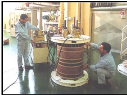
Figura 7.5 Formação de fases de uma bobine (transformador de potência)
