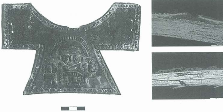
Fig. 6 Peitoral peruano em liga Ag-Cu: material severamente trabalhado a frio (encruado); secção de corte evidencia a corrosão preferencial ao longo das linhas de deformação.
