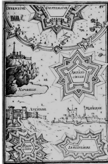
Fig. 18 – Desenho de Allain Mallet representando diferentes tipologias construtivas de fortificações. Fonte: Les Travaux de Mars ou L' Art de la Guerre . Paris: Denys Thierry, 1661, p.47.
