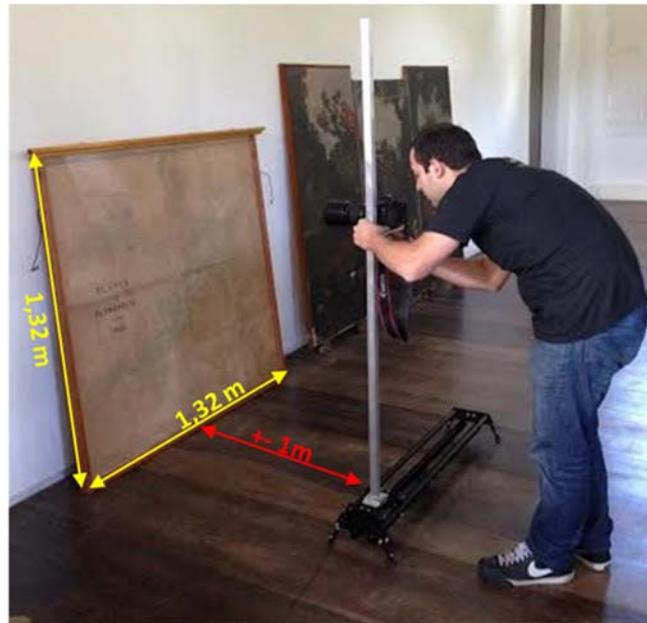
Figura 6. Sistema utilizado com o trilho, baliza e câmara digital de alta resolução para levantamento fotográfico da planta Koeler.
