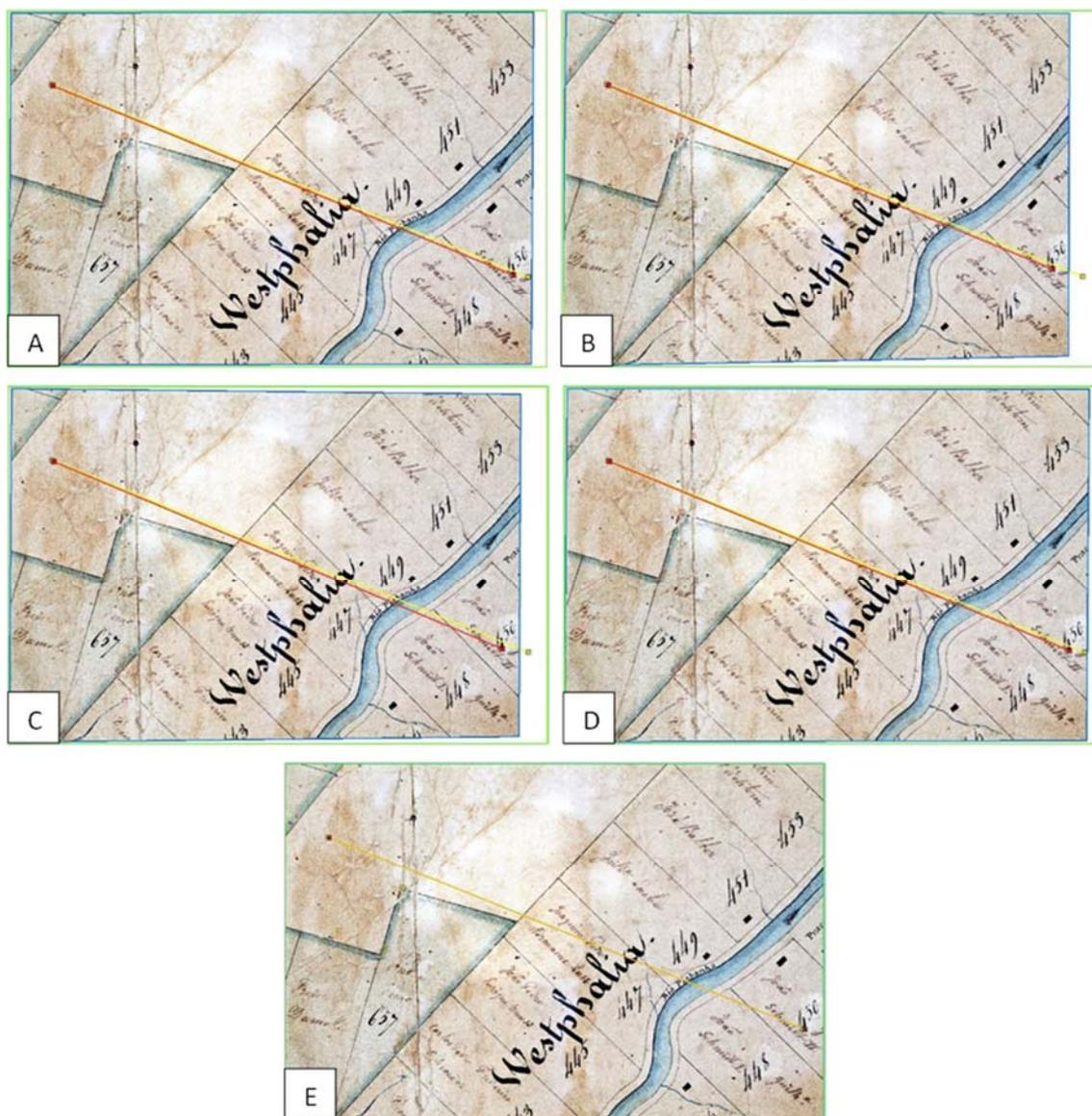
Figura 14. Exemplos da fotografia 5067 após o georreferenciamento. Sendo o resultado A utilizando a transformação *1<sup>st</sup> Order Polynomial (Affine)*, B utilizando a *2<sup>nd</sup> Order Polynomial*, C utilizando a *Projective Transformation*, D utilizando a *Spline* e E utilizando a *Zero Order Polynomial (Shift)*.
