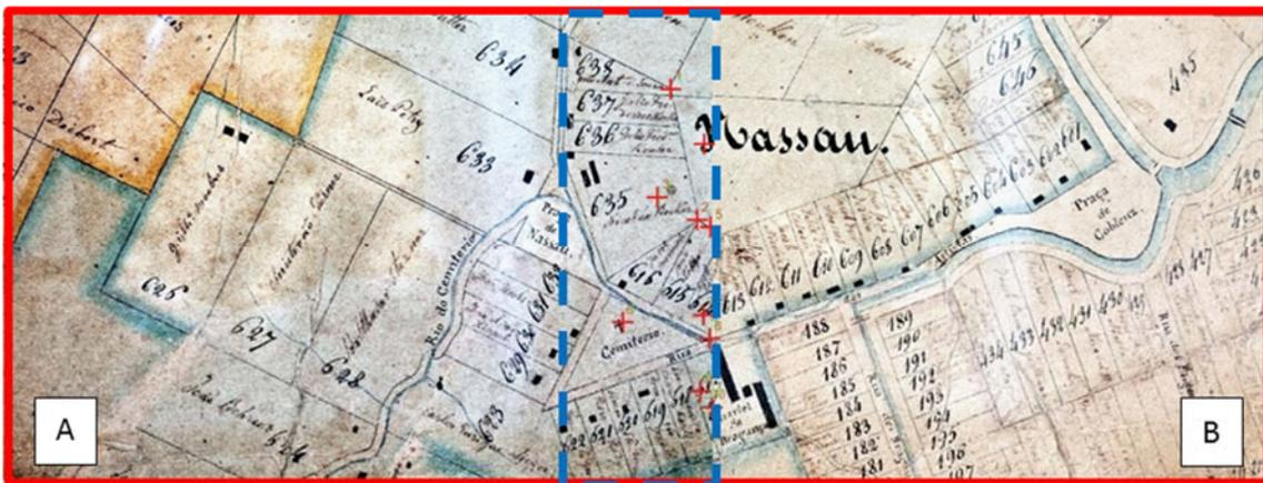
Figura 8. Mosaico do par de fotografias. Em vermelho a área total das duas fotos utilizadas, em azul a área de sobreposição de onde foram extraídos os pontos de controle, e as cruzetas vermelhas são os pontos de controle.
