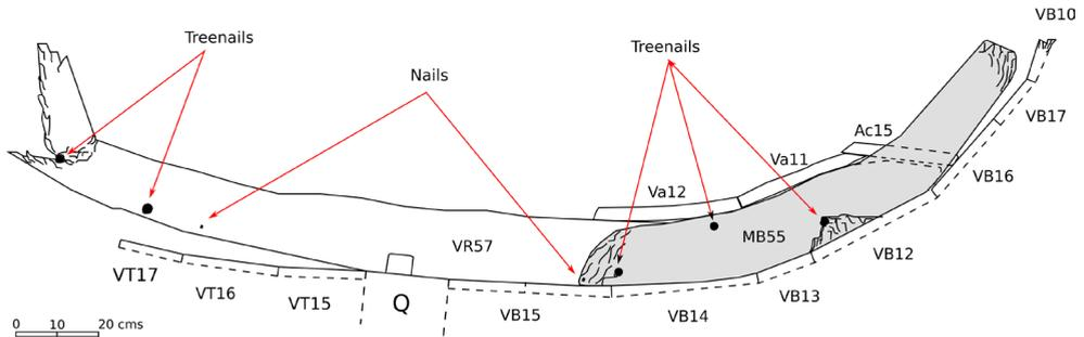
Fig. 1.12. The master frame VR57 (floor timber)/VR55 (futtock)
