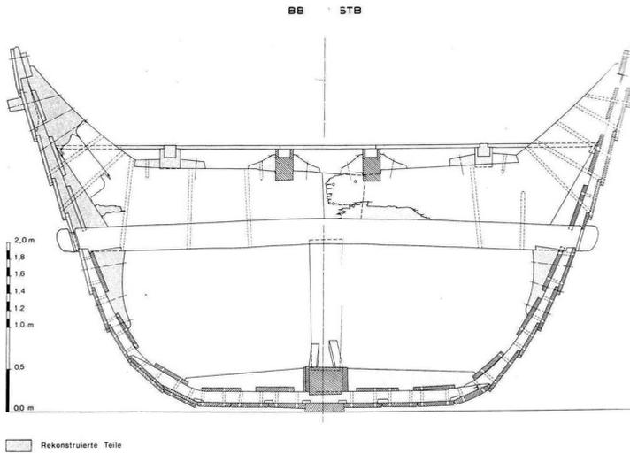
Fig. 2.31. Central section of the «Bremen cog»
