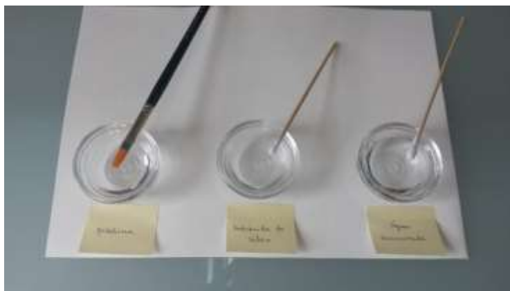
Fig. 14 – Produtos utilizados (água desionizada, hidróxido de cálcio e gelatina) e materiais de aplicação. Fotografia da autora.
