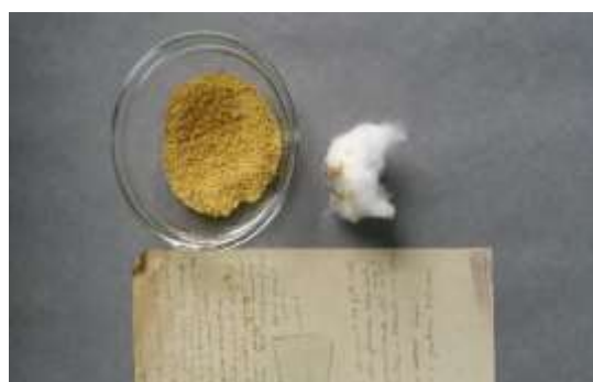
Fig. 8 – Limpeza mecânica: borracha em pó e algodão. Fotografia da autora.
