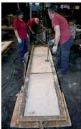
Segue-se o preenchimento das metades da caixa de fundição com areia e subsequente compactação da mesma. A imagem mostra o preenchimento da caixa inferior, que não necessita de respiros nem canais de ataque.
