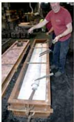
Na caixa superior, e antes de se preencher a mesma com areia, são planeados os respiros e canais de ataque através do posicionamento de utensílios de madeira.
