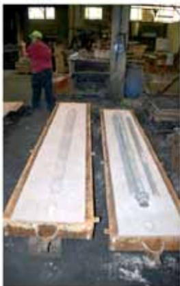
Após a compactação e secagem da areia em ambas as partes da caixa de fundição, procede-se à sua abertura para retirada do molde. O molde é, então, desencaixado nas suas diversas partes, um processo que se designa de dar saída ao molde.
