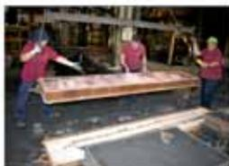
De seguida, a caixa superior é posicionada sobre a caixa inferior já com o macho alinhado na posição correta.
