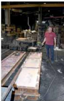
No caso da moldação do fuste de uma coluna, é utilizada uma areia auto-secativa que necessita de ser submetida à combustão de gás propano sobre a sua superfície para obter solidez estrutural.
