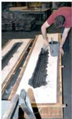
O produto da moldação é coberto com uma tinta específica, que lhe confere robustez (e impede que o molde se danifique durante a fundição), e são dispostos os chapelins, utensílios que asseguram o correto posicionamento do macho.
