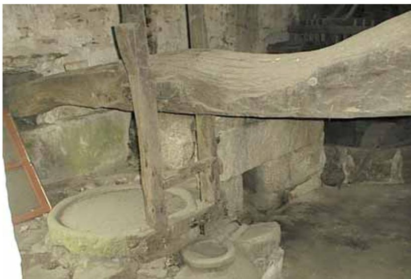
Figura 5.2- Mondim de Basto. Pormenor de prensa para vinho, com grande viga em carvalho apoiada no vão existente na parede do lagar.
