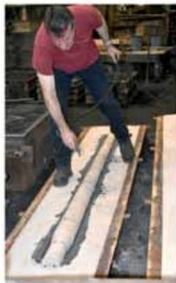
Depois de concluído, o macho é posicionado sobre a moldação previamente realizada na caixa inferior de fundição. Para garantir um melhor acabamento da peça final a estrutura é limpa através de ar comprimido que solta qualquer partícula de areia que não se tenha consolidado durante a secagem.
