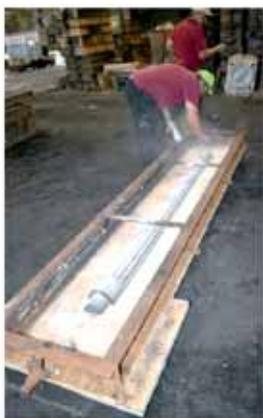
O processo inicia-se com a disposição de uma metade do molde em cada uma das metade da caixa de fundição. O molde é de seguida coberto com pó de apartar.
