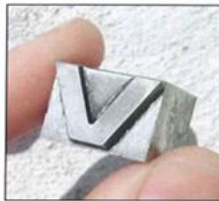
Figura 3 – Caractere de impressão em liga de antimónio (1/3) e chumbo (2/3). Fonte: Moura, A. (2010). Metais e semi-metais de Portugal. Coimbra: Palimage.
