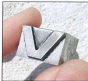
Figura 3 – Caractere de impressão em liga de antimônio (1/3) e chumbo (2/3). Fonte: Moura, A. (2010). Metais e semi-metais de Portugal . Coimbra: Palimage.
