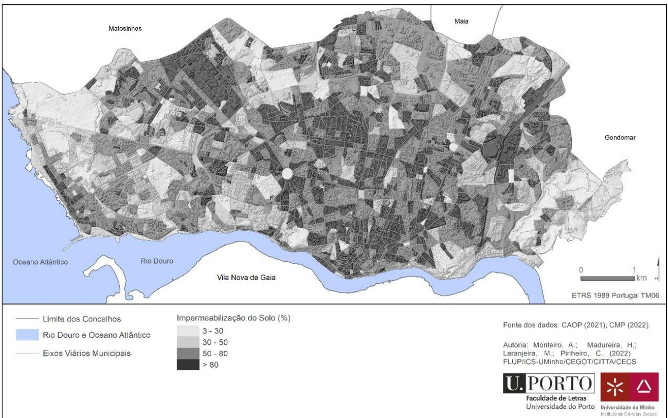
Figura 3 – Proporção de área impermeabilizada por subsecção estatística (2011)
