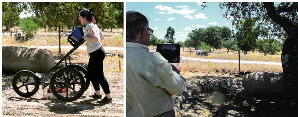
Fig. 7. Campanha de prospeção geofísica com georadar
