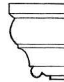
3 — Modenatura da imposta. Esc. 1/10.
