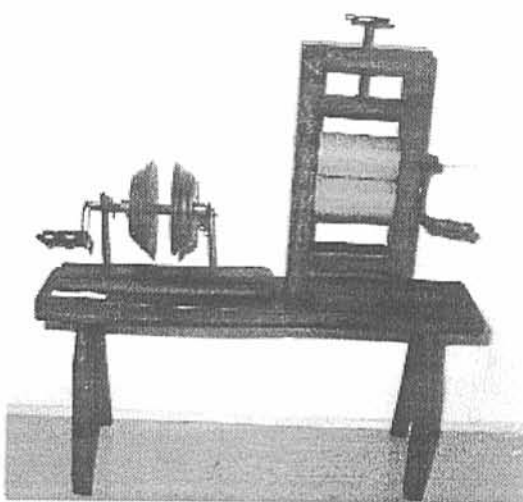
Fig. 5 — Acção de passar, segundo a Encyclopédie e banco com a roda de passar e a de rebobinar
