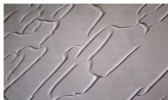
FIGURA 5 - Macrofotografia de obra em acrílico que apresenta Crazing tipo “L” - mosaico direcional. Fonte: FRANÇA, 2008
